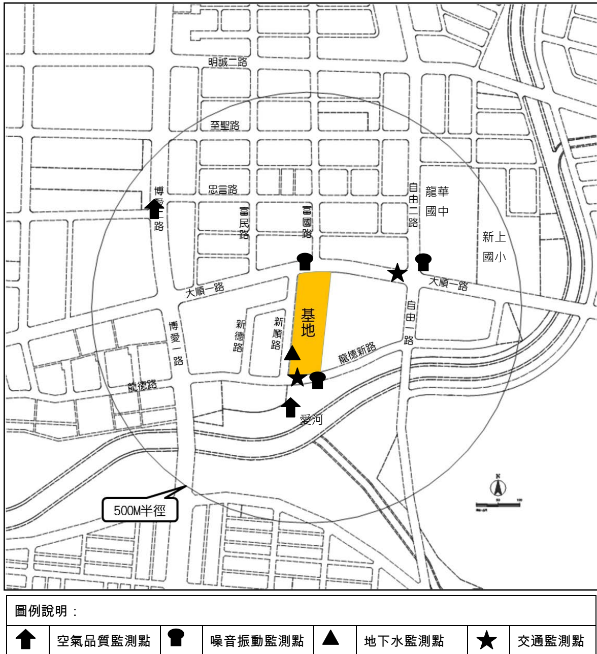
圖 1.4-1 施工期間環境監測位置圖
