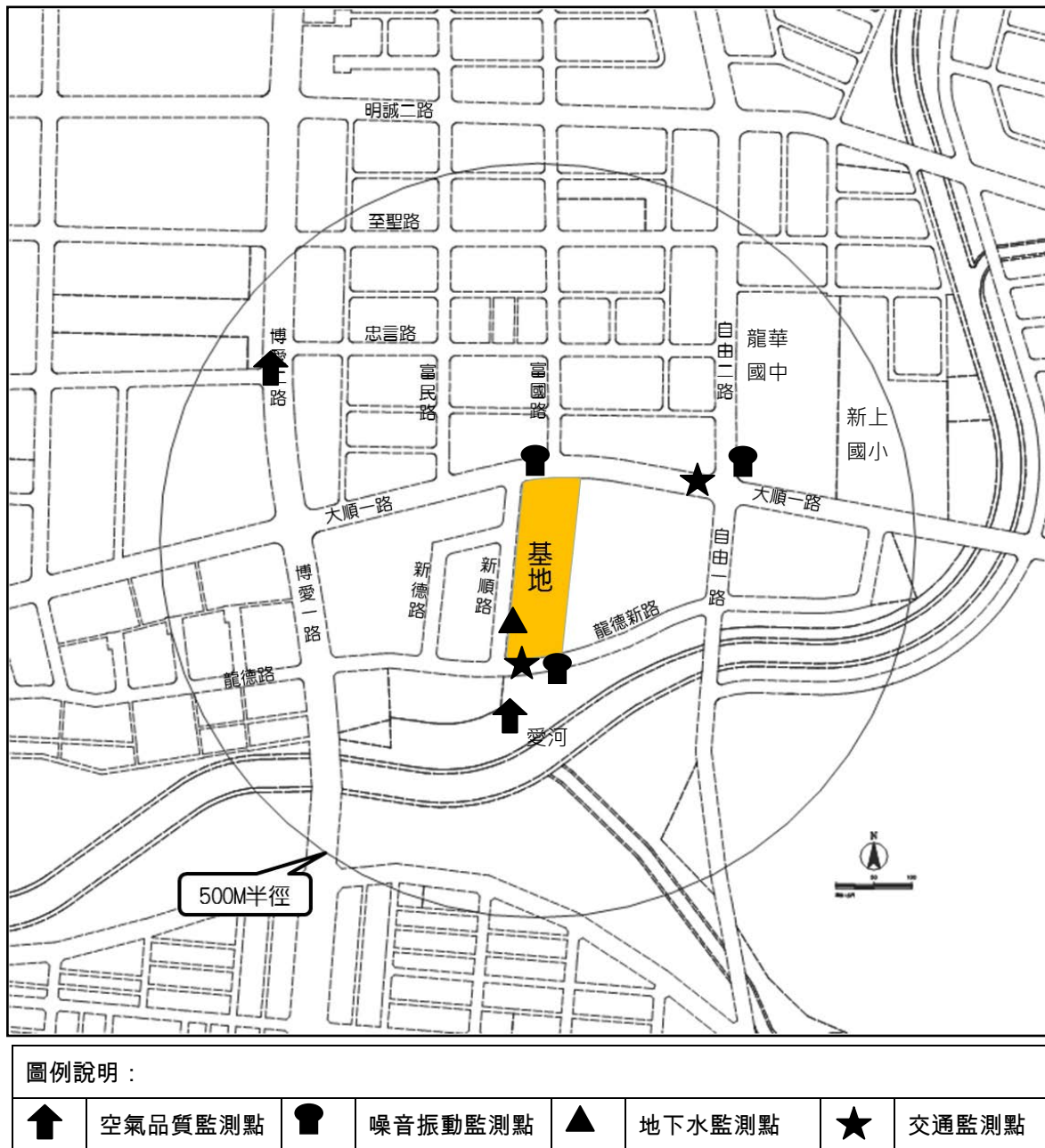
圖 1.4- 1 施工期間環境監測位置圖
