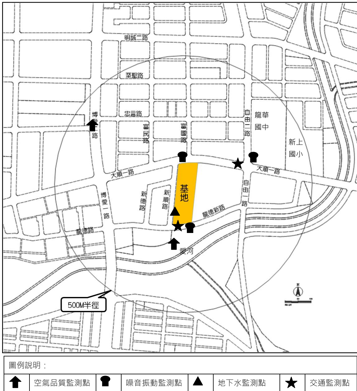
圖 1.4- 1 施工期間環境監測位置圖
